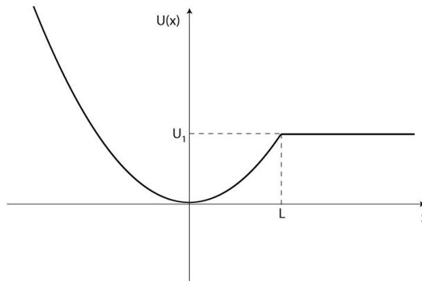
Considérons une particule de masse  $m$  soumise au potentiel de la Figure ci-contre. Pour  $x < L$ , le potentiel est celui d'un oscillateur harmonique,  $U(x) = m\omega^2x^2/2$ , tandis que pour  $x \geq L$  le potentiel est constant et vaut  $U_1$ . La fonction d'onde de l'état fondamental de ce système, dans l'intervalle  $x \in [-\infty, L[$  est celle de l'état fondamental d'un oscillateur harmonique. On fait l'hypothèse que l'énergie propre de cet état est  $E < U_1$ .
